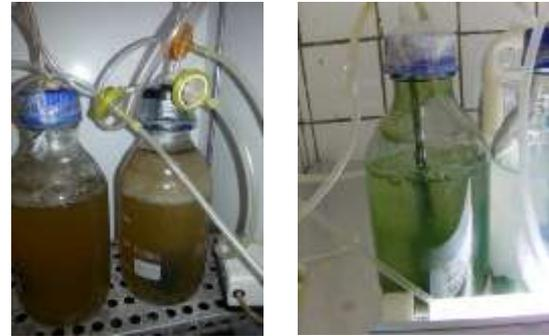
الشكل (1): مزارع الطحالب الكبيرة السعة ( مفاعل حيوي مبسط simple photobioreactor)
