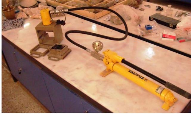
الشكل (2) جهاز تصنيع وفحص الطابوق الترابي المضغوط من اجل الفحص
