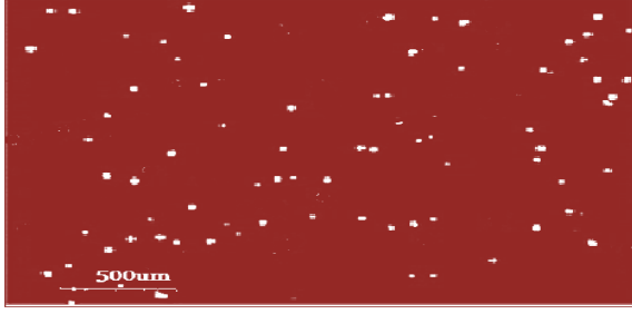
الشكل (2) آثار جسيمات الفا على الكاشف النووي
