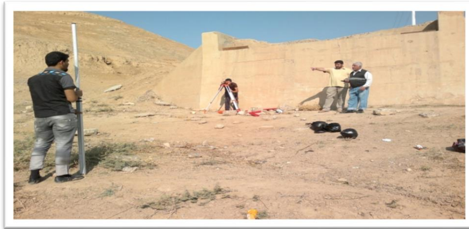
لوحة (4) استخدام جهاز level في مسح المقطع
