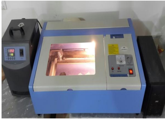
شكل (3): صورة لماكينة ليزر CO 2 مع منظومة التبريد
