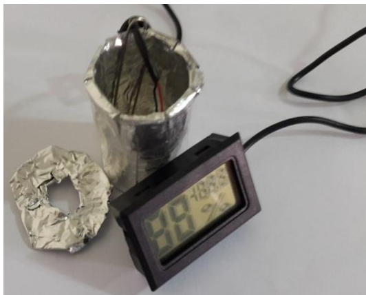
الشكل (4): صورة للمحرار الالكتروني المستخدم في قياس درجة الحرارة مع البيكر الزجاجي
