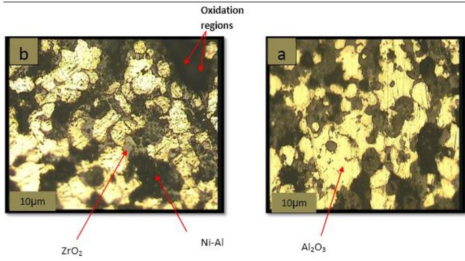
الشكل ( 1 ) يوضح المعاملة الحرارية للنماذج المحضرة عند: a- ( 950 °C ) b- ( 1050 °C )
